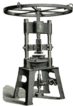
KÄSIKÄYTTÖINEN SEMENTTILAATTOJEN PURISTIN AJALTA ENNEN NYKYAIKAISTEN HYDRAULI-PURISTIMIEN KEKSIMISEN.
