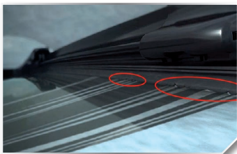
Cracked blade Poröses Wischgummi
