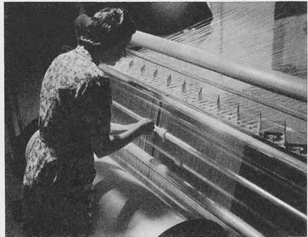
Moderne Warpe-Maskine paa A/S Th. Wessel & Vetts Væverier.
