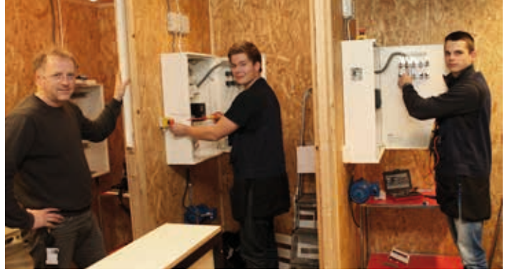
Christian Bjøntegaard (17) og Arnoldas Veta (18) på linjen elenergi VG2 monterer frekvensomformere for å styre hastigheten til motorer i hver sin «bås», mens faglærer Erik Strypet følger med.
