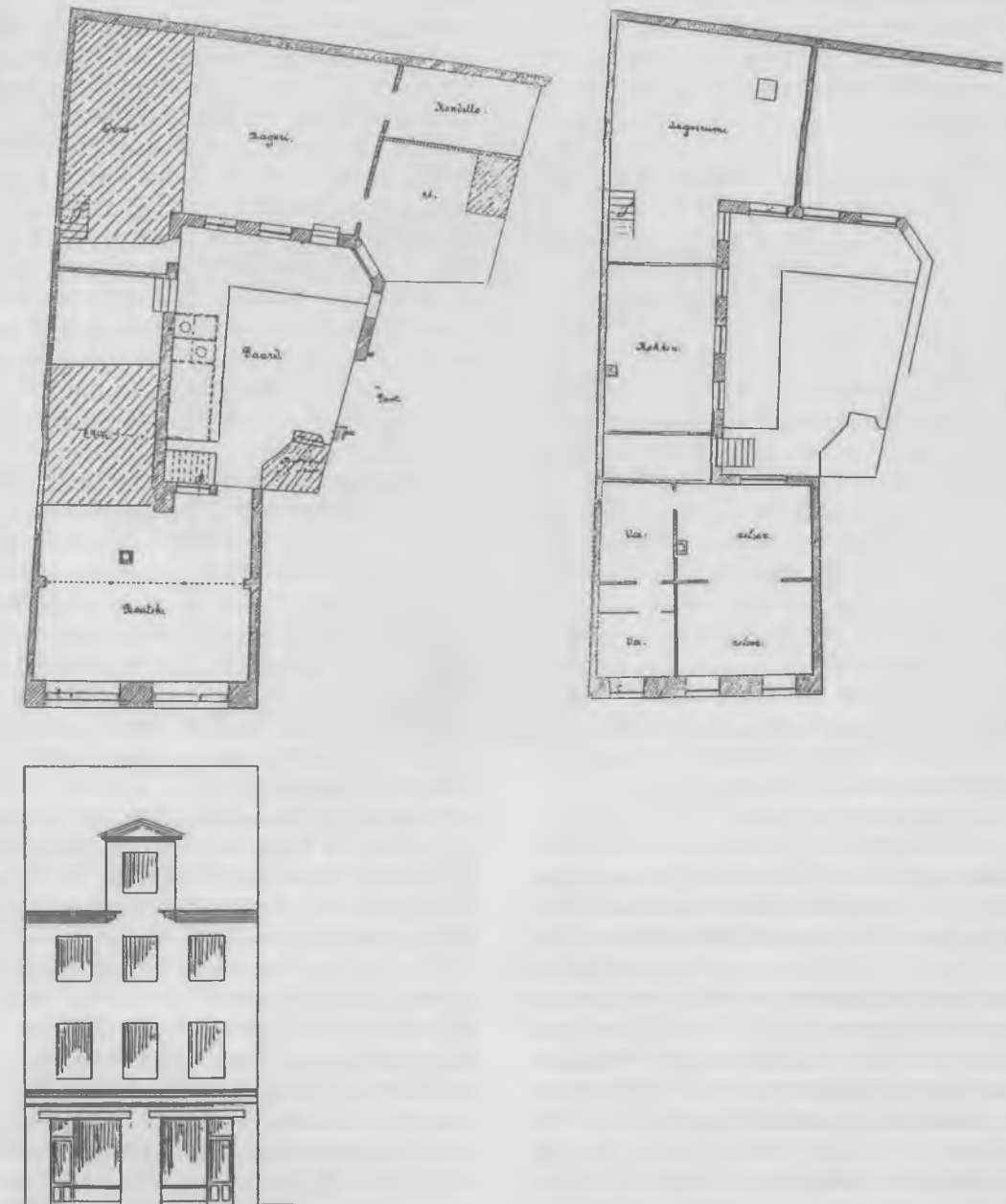
Fig. 6. Stueetagen og 1. sal samt facaden af Købmagergade 67 efter ombygningen i 1896, da der kom ny bageovn og en ny 49 alen høj skorsten mm. I 1850'erne var butikken blevet udstyret med nye spejlglasrunder, og i 1880 fik den det udseende, som er vist på tegningerne. En modernisering i 1890'erne medførte en ny disk, nye reoler og et forgyldt spejl med marmorkonsol (byggesager vedr. nedrevne ejendomme, KSA).
