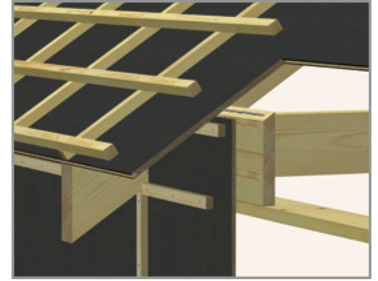
D9. Seinän ja katon liittymä vaihtoehto 1
