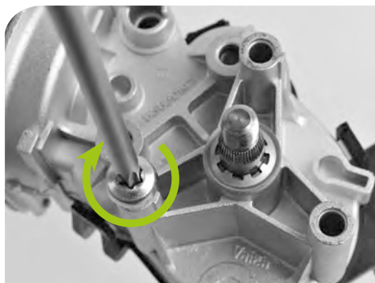
2 - Verwenden Sie gewindeformende Schrauben für den Einbau
