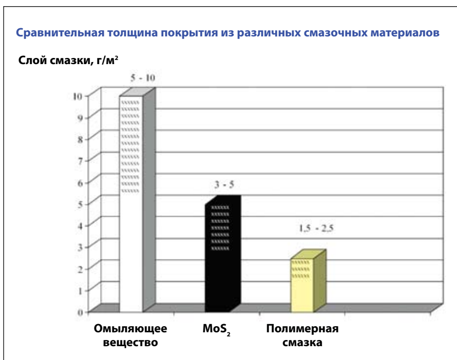
▼ Рис. 2. Сравнительная толщина покрытия из различных смазочных материалов
