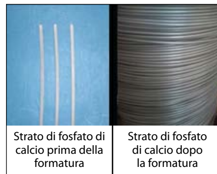
▲ Figura 4: Filo per stampaggio a freddo prima e dopo la formatura
