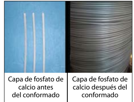
▲ Figura 4: Alambre para estampación en frío antes y después del conformado
