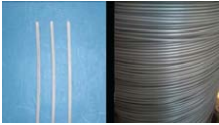
▲ Рис. 4. Проволока для холодной высадки до и после формования
