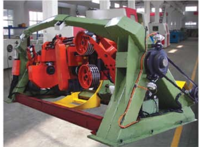
Ø800D-Ø2500D 型绞线机(束绞机) (生产效率高于管式绞线机3.5倍以上) Ø800D-Ø2500D Double twister
