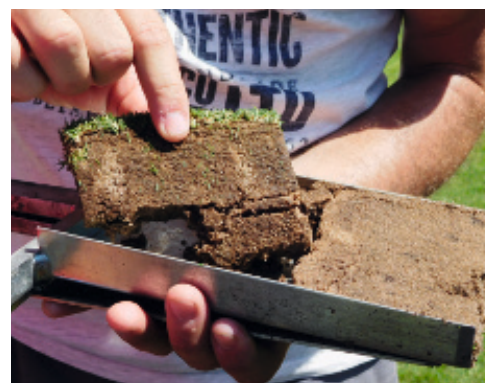
ARBEITSGERÄT Der Profilspaten ermöglicht den Einblick in die Rasentragschicht
