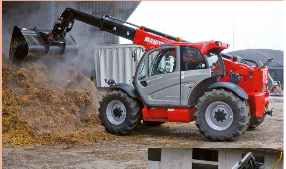
Jährlich schlägt der Manitou MLT 1040 für den Betrieb der Biogasanlage 5000 Tonnen Material um
