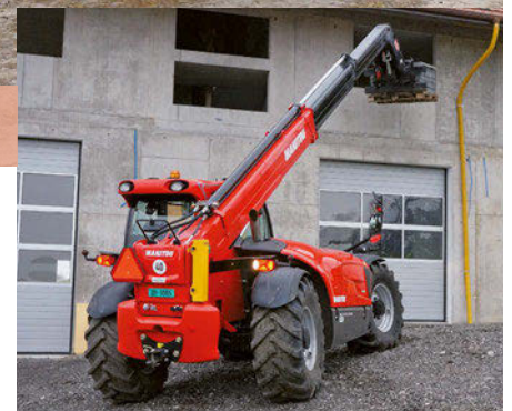
Der Niveausausgleich des MLT 1040 ermöglicht, Material unabhängig vom Gelände horizontal vor eine Gebäudeöffnung zu liefern
