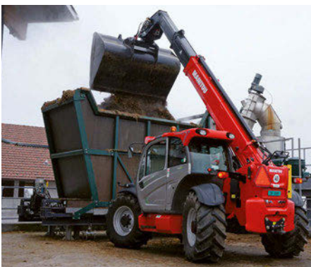
Mit der Leichtgutschaufel schafft der Manitou in 5 bis 6 Fahrten rund 15 m 3 Material in die Biogasanlage
