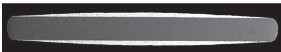
▼ Bild 3: Querschnitt eines typischen feuerverzinnnten Kupfer-Flachdraht
