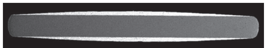
▼ Рисунок 3: Поперечный профиль стандартной медной лентой, луженой горячим способом
