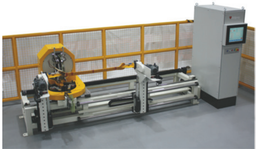
▲ Neue fortgeschrittene NCT Bandagiermaschine für enge Spulen von Ridgway
