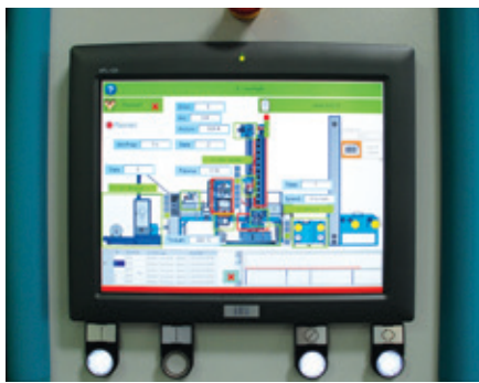
▲ Figura 6: Interfaccia HMI con schermo tattile, di facile utilizzo sulla linea di stagnatura PlasmaPREPLATE
