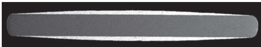
▼ Figura 3: Sección transversal de una cinta de cobre estañada por inmersión en baño caliente convencional
