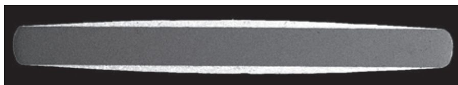
▼ Figura 3: Sezione trasversale di un nastro di rame stagnato per immersione in bagno caldo tradizionale
