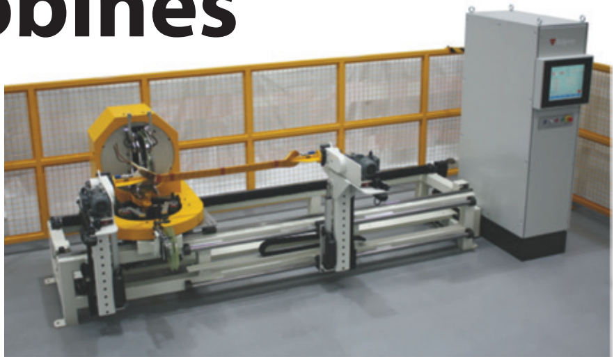
▲ Nouvelle rubaneuse NCT pour bobines étroites de Ridgway
