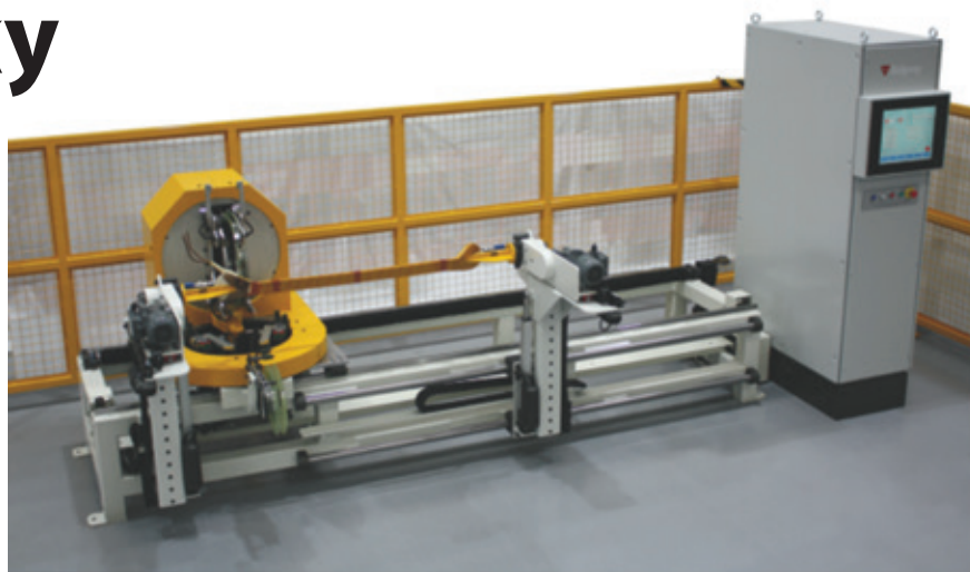
▲ Новые усовершенствованные устройства намотки для узких катушек от «Ridgway»
