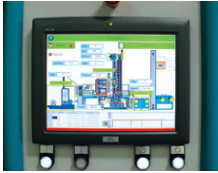
▲ Bild 6: MMS mit einer Touchscreen-, benutzerfreundlichen Schnittstelle an der PlasmaPREPLATE-Verzinnungslinie
