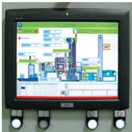
▲ Рисунок 6: HMI-интерфейс с сенсорной панелью, удобной для использования на линии плазменного лужения
