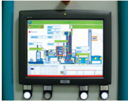
▲ Figura 6: Interfaz HMI con pantalla táctil, fácil de usar en la línea de estañado PlasmaPREPLATE
