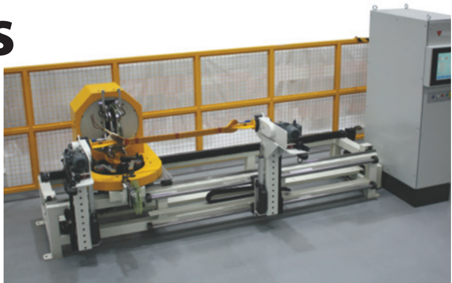
▲ Nueva encintadora NCT para bobinas estrechas de Ridgway
