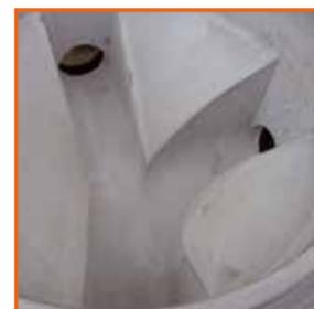
Lors de faible différentiel d'altimétrie amont /aval entraînant une faible vitesse d'écoulement, nous concevons votre fond hydraulique monobloc avec canal en pente (max 10 %) pour favoriser l'écoulement sur la totalité de votre réseau.
