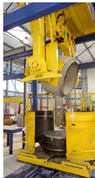
Le Béton auto-plaçant est la garantie de la résistance et de l'étanchéité par sa compacité, son homogénéité et la cohésion des bétons. En démoulage différé, il offre une fiabilité géométrique et des caractéristiques dimensionnelles constantes. Béton auto-plaçant, démoulage différé, 2 atouts pour obtenir une finition lisse parfaite du fil d'eau pour favoriser l'écoulement optimal des effluents dans la cunette.
