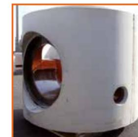
Du DN150 au DN800, l'intégration d'une cunette selon matériau (grès, prv, pp...) se fait lors de la fabrication, quel que soit l'angle demandé et après étude de faisabilité. Selon le matériau de branchement, nos réservations peuvent recevoir des manchons d'étanchéité sur-mesure.
