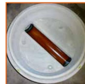
Intégration d'une cunette en grès sur fond hydraulique monobloc DN1000 permettant la parfaite continuité de fil d'eau sans décalage au raccordement entre la cunette du fond et la canalisation en grès. L'intégration sur-mesure de coquilles se fait en usine et selon type de matériaux de branchement.
