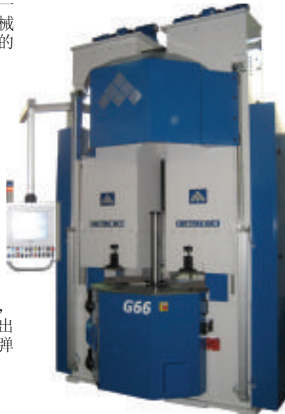
○ Kamatech G66TH1A弹簧磨床有两个工作头，在中间有电子压力器
