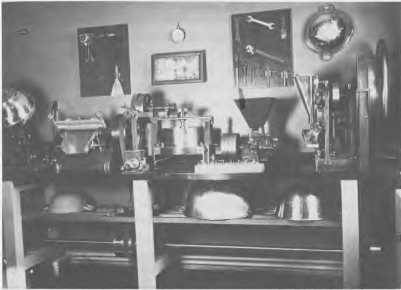
Interiør fra Søborg apotek ca. 1938 med fra venstre drageemaskine, salvemølle, kværn og tabletmaskine med fælles motortræk. Foto i privateje.
