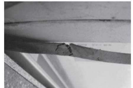
▲ Figure 1: Pannes de câblage causées par l'ozone et par les températures élevées
