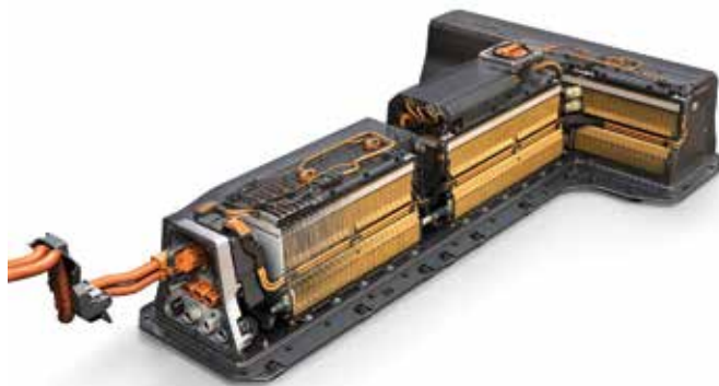
תמונה 1: מערכת המצברים של רכב הוולט
