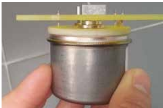
תמונה 3: הקונטקטור החדש למעגל מודפס ללא מארז ודפינה
