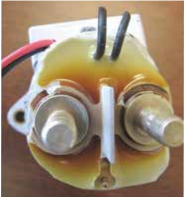
תמונה 6: השפעת טמפ' המגע על קונטקטור אטום אפוקסי
