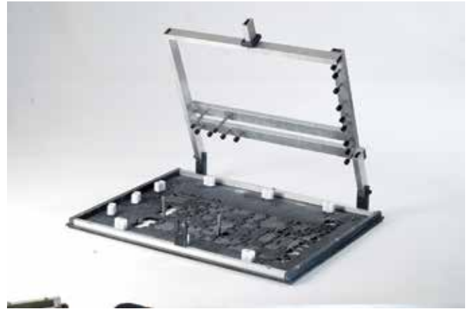
תמונה 1: מתקנים להלחמת גל סלקטיבי עם גשר תמיכה
