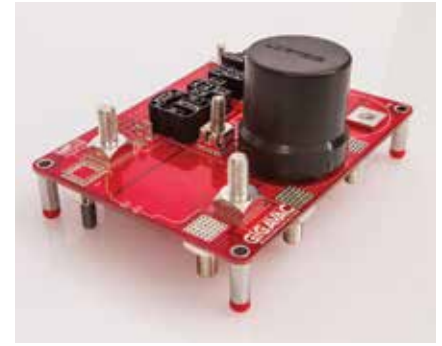
תמונה 4: אופן שילוב הקונטקטורים ישירות על המעגל מודפס
