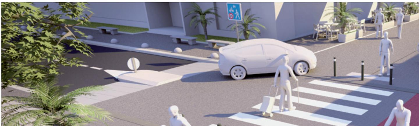
Réglémenté par la norme NF P 98-300, le ralentisseur de type trapézoïdal doit impérativement comporter un passage piéton.
