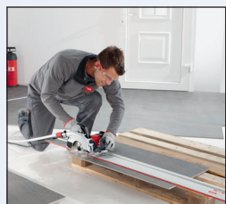
Tăiere pe distanțe lungi cu ajutorul șinelor de ghidare GRS
