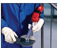
Datorită pietrei pentru profilare se poate realiza exact raza dorită
