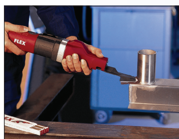
Polizare uniformă pâna în colț, datorită suportului "deget" și mișcării liniare
