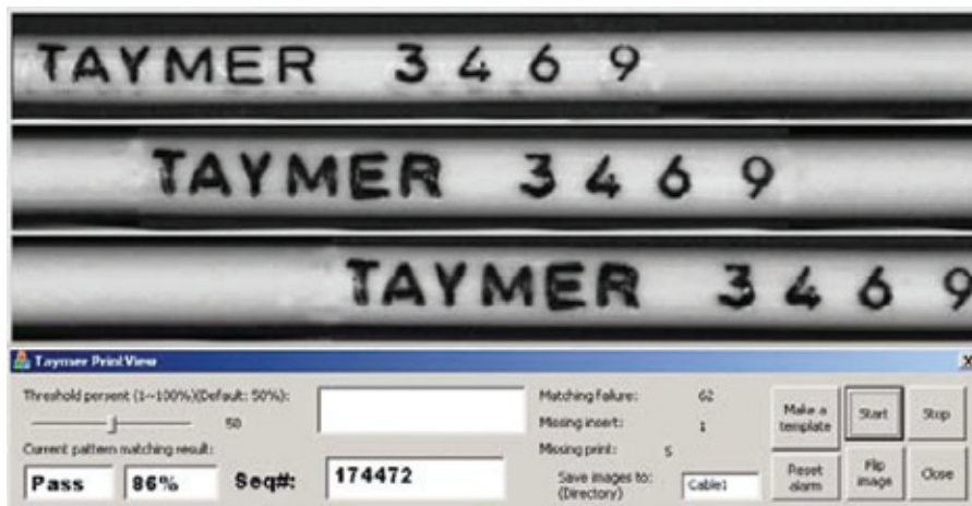
▲ Figura 5: Cattura di immagine dallo schermo della comparazione di qualità della marcatura
