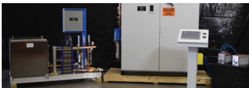
MHD供电、线圈和冷却系统
