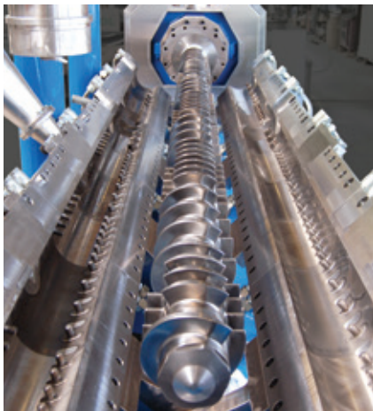
○ X-Compound的连续混炼机拥有广泛的应用，包括电缆材料的温和处理
