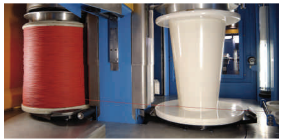
▲ SV410D全速自动换盘新一代双绕线机
