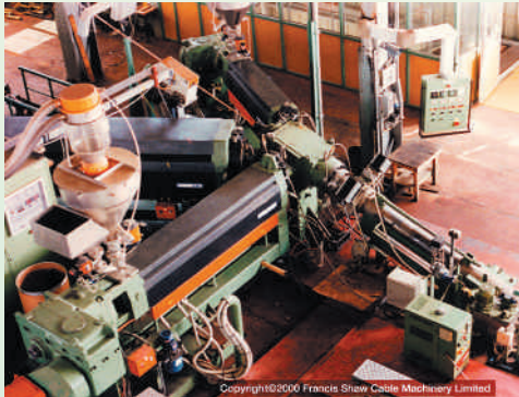
▲ 中压和高压电力电缆的三层挤出机组
