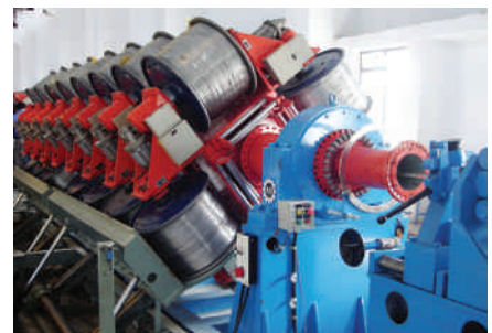
▲ AEI 128 框绞机在Universal电缆公司运转中
