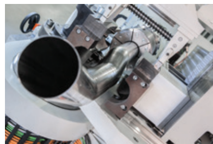
transfluid弯管机可弯曲直径达127毫米的管道，弯曲半径达1倍直径，还可以将壁厚减少2到1.5毫米
