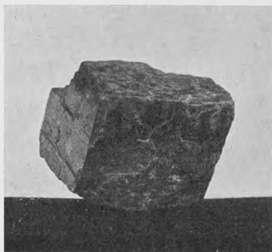
Jærnspat med Spalteflader
