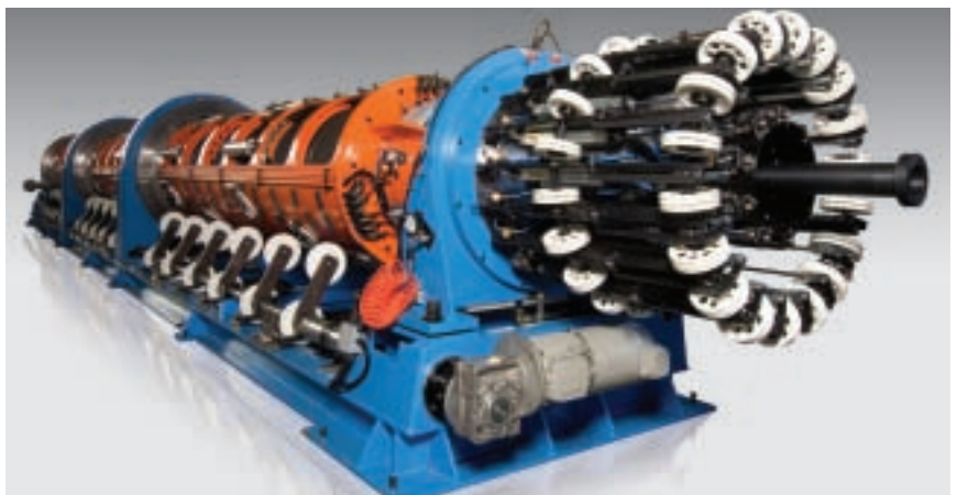
○ Cortinovis Machinery的中心管绞机
