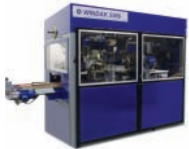
○ Windak的SW6线轴提供6个线轴/分钟
