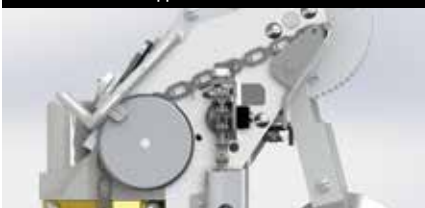
ON - Posizione di applicazione del nastro e dello stucco
