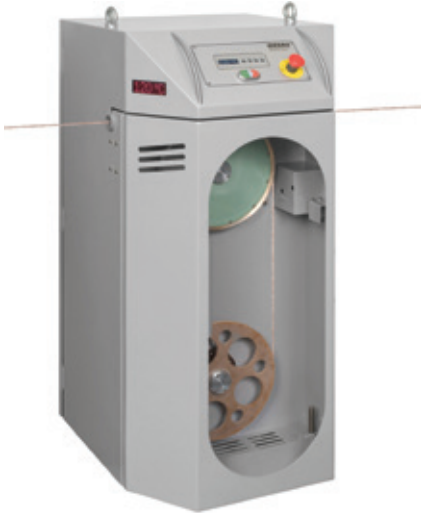
集成温度测量与控制的导体预热器
