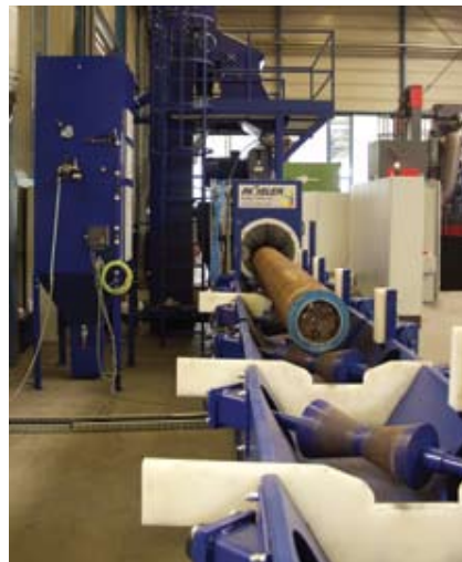
钢管由有效载荷为500公斤/运行米的轧辊输送机转移到喷砂机
