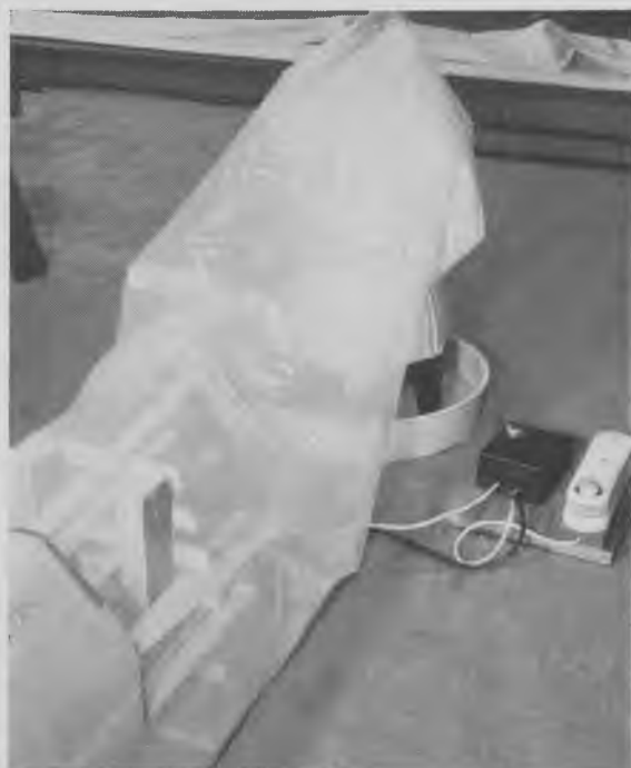
Kortet i plasticposen under tilførsel af fugtmættet luft. For enden af posen ses det tilkoblede luftfugtningsapparat, på gulvet de regulerende apparater
