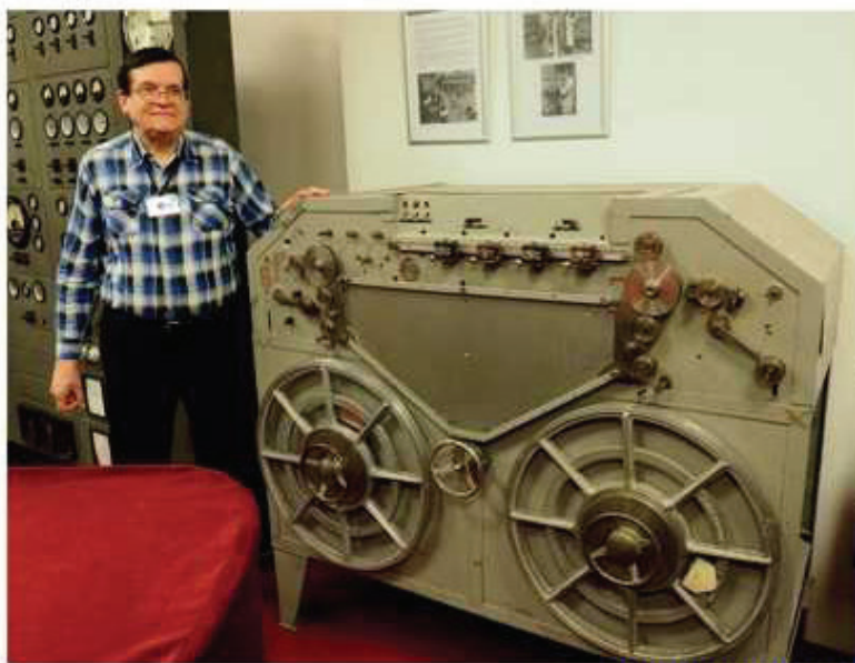
Pan Miloslav Turek z archivu Českého rozhlasu u záznamového přístroje Blatnerfon. Záznam byl magnetický a nahrávalo se na kovový pásek o šířce 3 mm, který se pohyboval vysokou rychlostí 1,5 m za vteřinu. Na ohromnou cívku s hmotností 15 kg se sice vešlo 2 700 m pásky, ale záznamová kapacita byla jen 30 minut.
