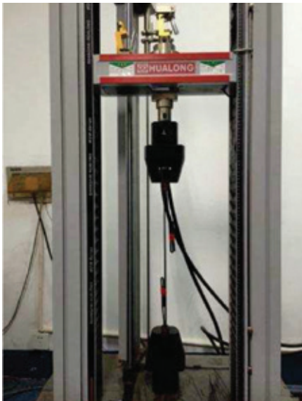
▼ Abb. 3: Prüfung der Zugfestigkeitsgrenze des Kabels
