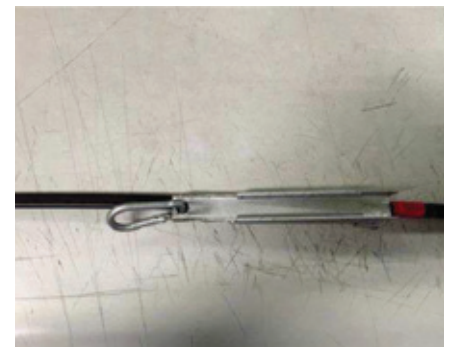
▲ Figura 2: Grapa de amarre usada para fijar el cable
