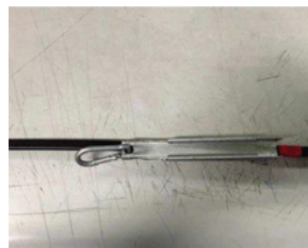
▲ Abb. 2: Die eingesetzte Abspannklemme um das Kabel zu fixieren
