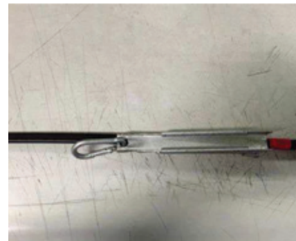
▲ Figura 2: Forcella di ancoraggio utilizzata per fissare il cavo
