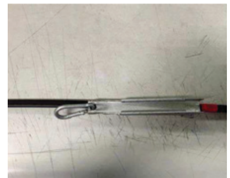
▲ Figure 2: Pince d'ancrage utilisée pour fixer le câble
