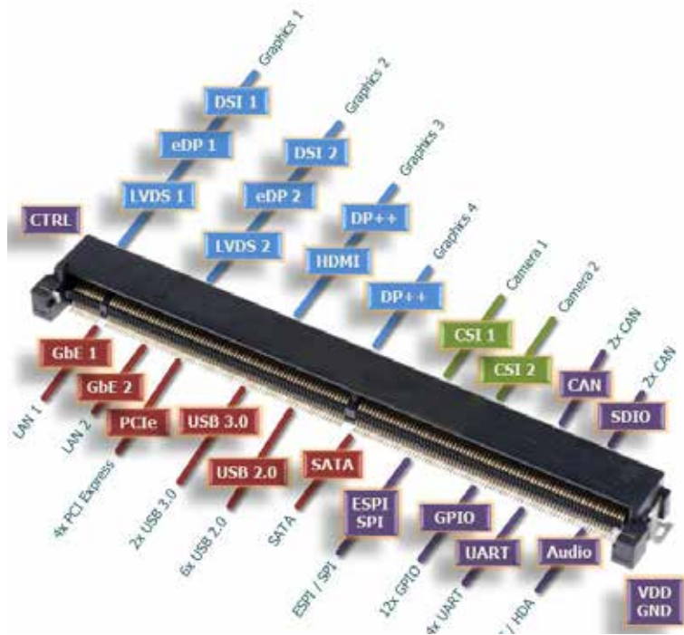
תמונה 1. הקצאת אותות לפי תקן SMARC 2.0 במחבר MXM-3 בעל 314 פינים
