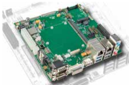
תמונה 3. לוח נושא SMARC 2.0 של MSC SM2- בתצורת Mini-ITX: MSC MB-EP1
